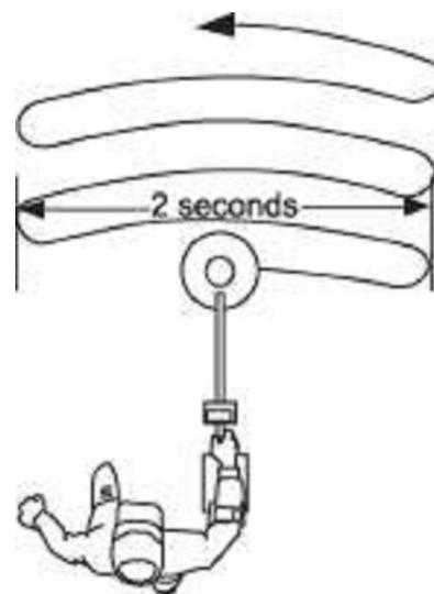
7. Твердые повторяемые звуковые сигналы и повторяемый показ значений на дисплее после нескольких проходов указывают интересную металлическую цель.
