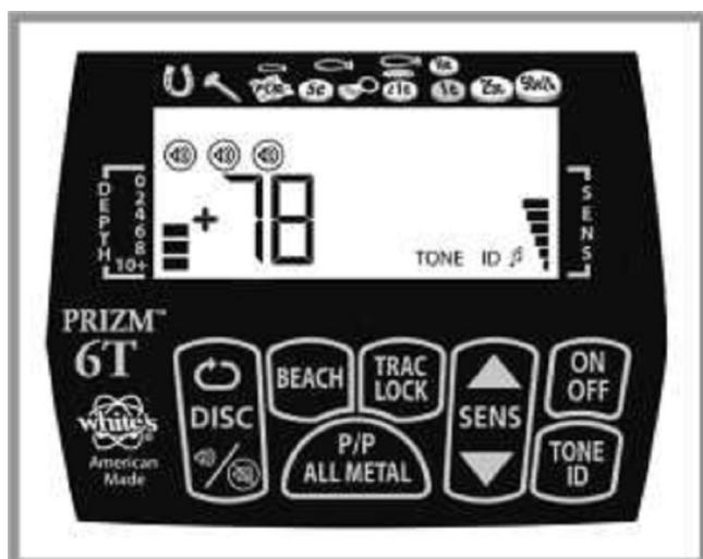
А. Определение точного положения цели с использованием VCO (Генератора управления напряжением). VCO производит прогрессивно повышающийся звуковой тон в то время, как сигнал от цели становится прогрессивно сильнее во время процедуры определения точного положения цели.
